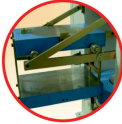
Özel Tuğla ve Bims Blok Aparatlı test Presi
