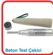
Beton Test Çekici
