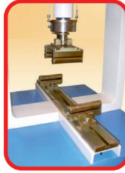
Bordür ve Beton eğilme Test Presi
